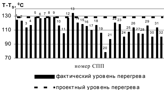
Рисунок 1. Уровень перегрева нагреваемого пара на выходе из сепараторов-пароперегревателей энергоблоков Ленинградской АЭС (данные 2005 года).
